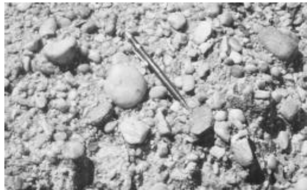
FOTO 4. Detalhe de fácies conglomerática fina, mostrando o elevado grau de arredondamento dos seixos e grande maturidade mineralógica do material (os clastos são compostos exclusivamente por quartzito e quartzo de veio).
